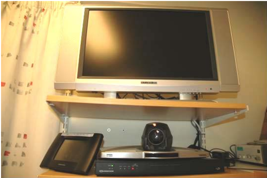
Bilde 3 viser deler av videokonferanseløsning (skjerm m/ innebygde høyttalere, kodek med kamera og Crestron touch panel og Ethernet kontroll system) på intensivrommet på LYB.
