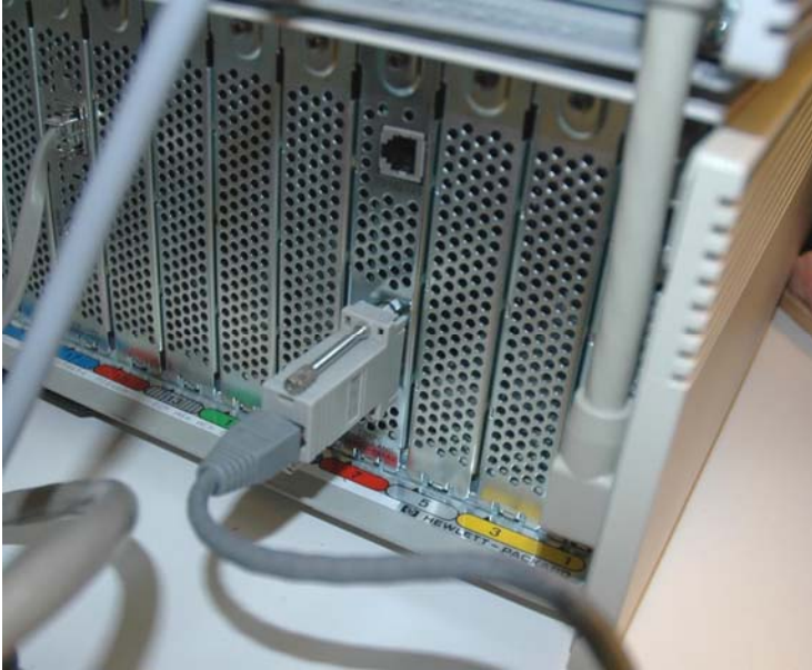
Bilde 7: bildet viser baksiden av "skopet". Her vises tilkobling til RS232-plugg og noe av den spesiellagede kabelen til teknisk løsning i prosjektet.
