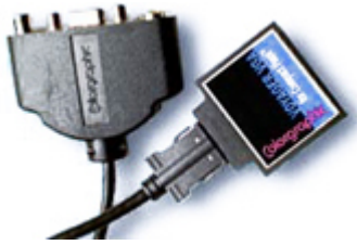
Figur 23. VGA, SVGA, wide VGA og XGA support gjennom HD15 VGA tilknytning og CF-grensesnitt mot PDA-er. NTSC og PAL TV-ut support gjennom S-video eller composite, mulighet for endring av retning, sentrering og forstørrelse av bilde. Produsert av amerikanske Colorgraphic ( http://www.colorgraphic.net ).
