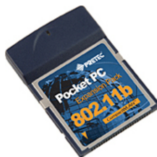
Figur 16. IEEE 802.11b-kort med CF-grensesnitt. Kortet er produsert av amerikanske Pretec Electronics Corporation ( http://www.pretec.com ).
