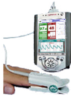
Figur 25. Puls-oximeter med CF-grensesnitt, produsert av amerikanske Dolphin Medical Inc. ( http://www.dolphinmedical.com ).
