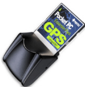
Figur 19. GPS-mottaker med CF-grensesnitt, produsert av amerikanske Pretec Electronics Corporation ( http://www.pretec.com ).
