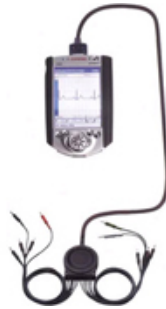
Figur 24. EKG-apparat med CF-grensesnitt, produsert av australske Micromedical Industries Ltd. ( http://www.micromed.com.au ).
