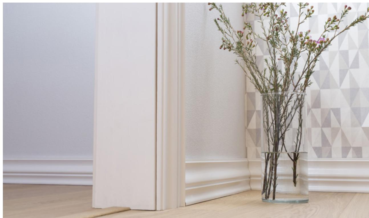
Utforing er produsert med en fjær/leppe som festes inn i dør- eller vinduskarmen og med tilpasset bredde utligner den avstanden mellom karmen og helt ut til veggmaterialet slik at man kan montere karmlist. Utforinger er med andre ord bindeleddet mellom dør- eller vinduskarm og selve karmlisten og en viktig og nødvendig del av belistningen.
