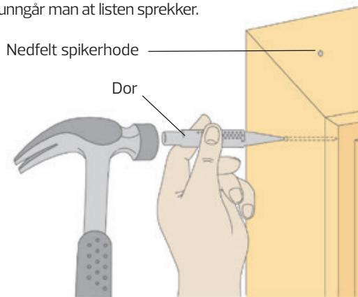
Spikerhodet, som slås ca 2 mm inn i treverket, kan dekkes ved sparkling. Sparkelen skal fyllespikerhullet. Etter torking kan sparkeloverflaten slipes jevn før maling. Det finnes også plastisk tre i ulike trefarger, dette kan benyttes hvis treverket skal være ubehandlet.
