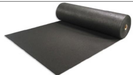
Akustikkduker brukes ved montasje av trespiler og spilepaneler for å oppnå lyddempende effekt i rommet. Våre akustikkduker er testet og utviklet for best mulig resultat i så måte. Effekt avhenger av montasjemåte, bakenforliggende isolasjon og avstand mellom spilene. Spør oss gjerne om rådgivning mht dette.
