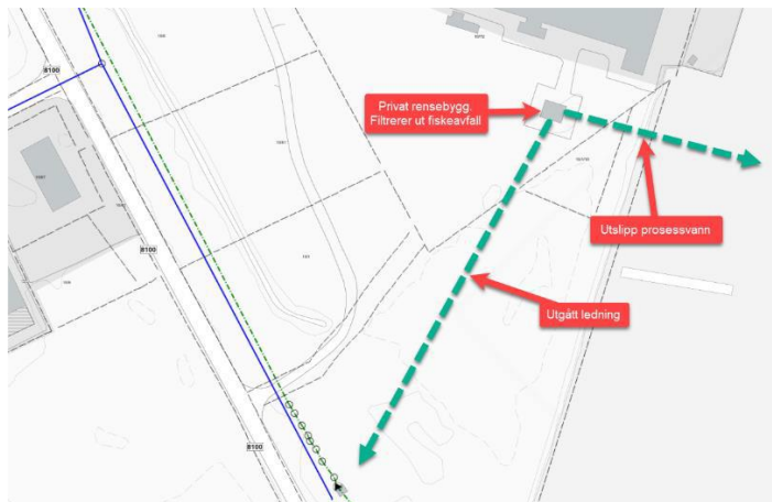
Figur 39: Omtrentlig rørtrase prosessavløp Arctic Catch.
