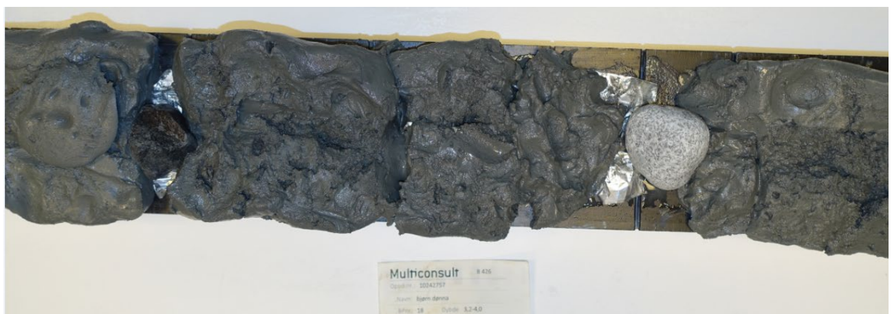
Figur 4-4: Sylinderprøve fra 3,2-4,0 m dybde i BP. 18. Siltig, sandig leire.
