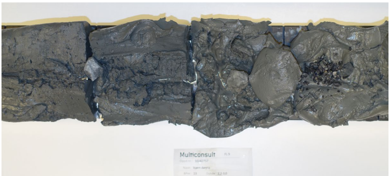
Figur 4-3: Sylinderprøve fra 2,2-3,0 m dybde i BP.13. Siltig kvikkleire.
