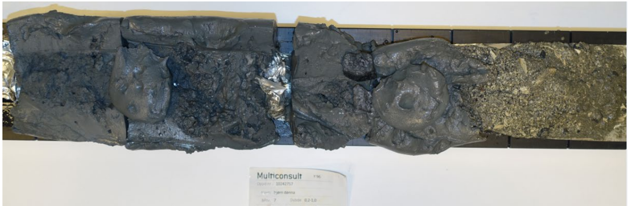
Figur 4-2: Sylinderprøve fra 0,2-1,0 m dybde i BP. 7. Korallsand øverste 10 cm, før overgang til siltig kvikkleire.
