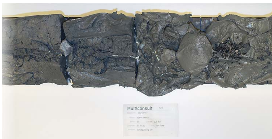
Figur 2-5: Cylinderprøve i BP. 13, dybde 2,2 - 3,0 meter. Siltig kvikkleire og sprøbruddsmateriale
