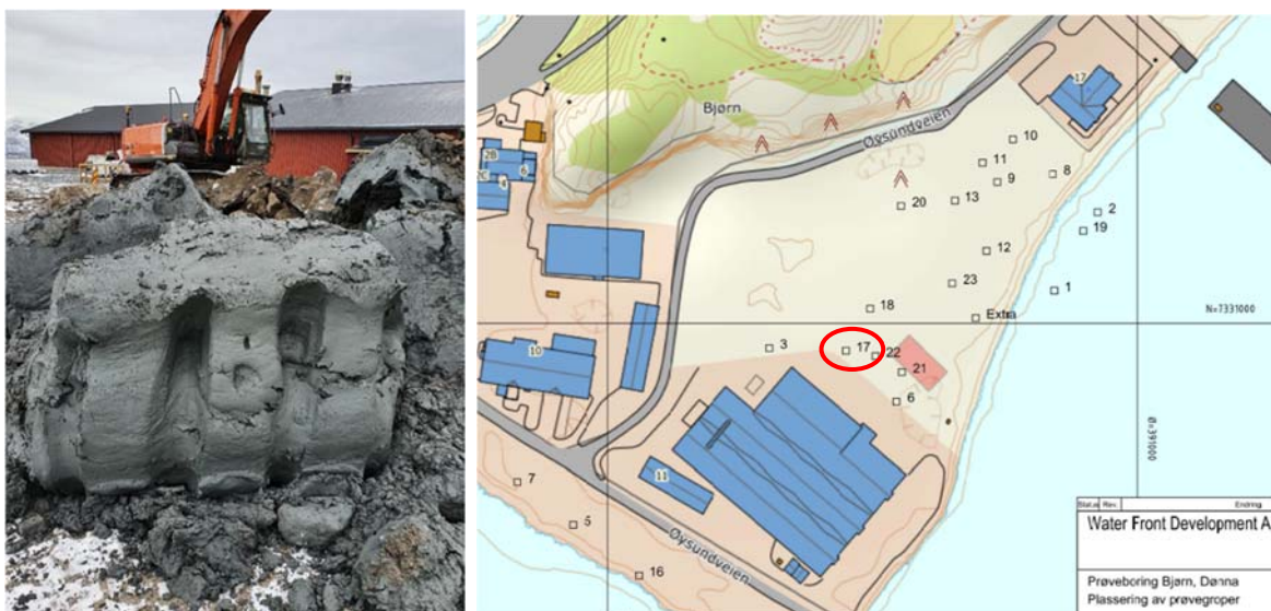
Figur 2-6: Foto fra prøvegrep nr. 17 som viser bløt leire, og utklipp av tegning 10216894-01. [Sweco, 7]
